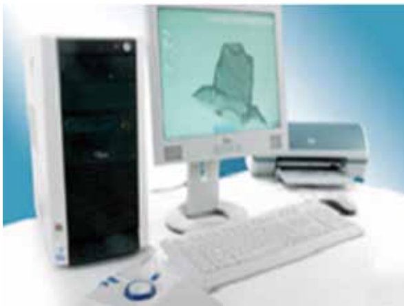
Fig. 20a. La computadora con el software Cercon Art acoplado al sistema de digitalización y diseño CAD, y transmisión de datos para la unidad fresadora.
