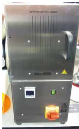
Fig. 13c. Horno para sinterización Zirkonofen 600 V2 (tem max 1700°).
